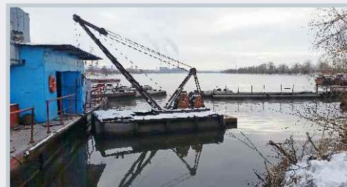
Плавучий кран для проведения работ на земснарядах, пульпопроводах.
